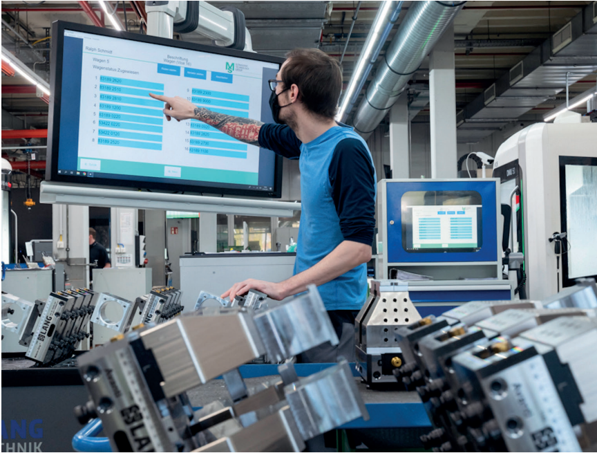
4 Bei der MS Ultraschall Technologie werden manuelle Bestückung der Automation und Entnahme der Werkstücke mit Tulip digital erfasst © DMG Mori
